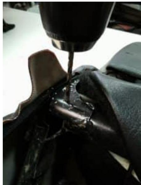
Fixer les deux petites languettes avec un rivet pop et une rondelle.
