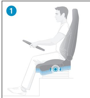
**RECARO Komfort-Plus:** Aby wyjść z pojazdu, za pomocą przełącznika (6) szybkiego opuszczania siedzenie należy ustawić w najniższej pozycji. Jeżeli przełącznik zostanie przełączony ponownie do góry, to siedzenie przemieszcza się za pomocą funkcji Memory automatycznie do ustawionej poprzednio pozycji wysokości.
