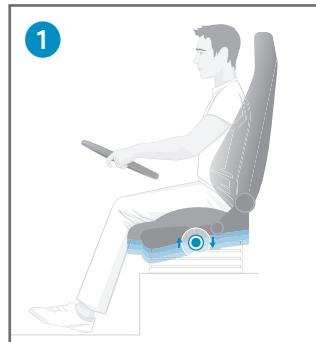
**Ihr RECARO Komfort-Plus:** Mit dem Schalter (6) für die Schnellabsenkung bringen Sie den Sitz zum Aussteigen in die niedrigste Position. Wenn Sie den Schalter wieder nach oben stellen, fährt der Sitz per Memory-Funktion automatisch wieder in die vorher von Ihnen eingestellte Höhenposition zurück.
