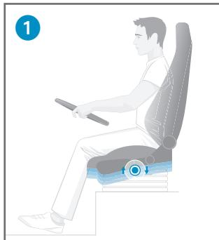
**Uw RECARO Comfort-Plus:** Met de schakelaar (6) voor de snelle verlaging zet u de stoel in zijn laagste stand om uit te kunnen stappen. Wanneer u de schakelaar weer omhoog zet, gaat de stoel dankzij de memoryfunctie automatisch terug naar de vooraf door U ingestelde hoogte.
