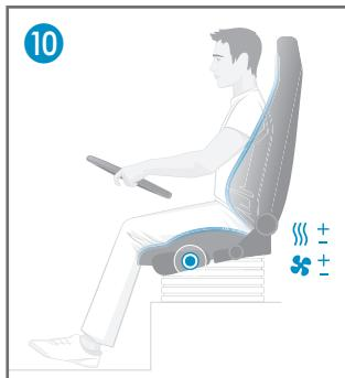
**Su plus de confort RECARO:** El asiento RECARO C 7000 posibilita, por primera vez en un asiento de vehículo industrial, el uso simultáneo de ventilación y calefacción, con lo que se consigue una climatización del asiento excepcional. El tejido 3D Aero del RECARO C 7000 permite el paso del aire, contribuyendo así a una excelente capacidad de climatización.
