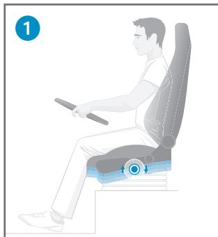
**Votre plus de confort RECARO:** Avec le commutateur (6) pour l'abaissement rapide, vous amenez le siège sur sa position la plus basse quand vous voulez sortir du véhicule. Lorsque vous ramenez le commutateur sur sa position haute, la fonction de mémoire permet de ramener automatiquement le siège sur la position en hauteur que vous avez réglé auparavant.
