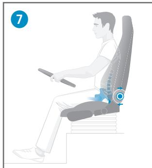
**O RECARO conforto extra:** Com o apoio anatómico da bacia correctamente posicionado, a parte superior do corpo é mantido automaticamente numa posição direita, para que sejam evitadas queixas de cansaço e tensão.
