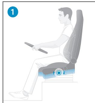
**Il Comfort Plus RECARO:** Con l'interruttore (6) per l'abbassamento rapido portare nella posizione più bassa il sedile per sollevarlo. Riportando nuovamente l'interruttore verso l'alto, il sedile torna automaticamente nella posizione in altezza regolata in precedenza grazie alla funzione Memory.
