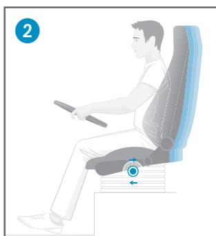
**Uw RECARO Comfort-Plus:** Met de nieuwe comfortontgrendeling (8 optioneel), een lus aan de voorzijde van het stoelkussen, wordt de afstand naar de bediening van de instelling in lengterichting verkort en hoeft u niet meer omlaag te buigen naar de cabinevloer.
