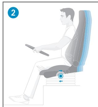
**Il Comfort Plus RECARO:** Con il nuovo sbloccaggio comfort (8, optional), un anello di cintura sul bordo anteriore del cuscino di seduta, si può accorciare il percorso della maniglia per la regolazione longitudinale e non è più necessario piegarsi fino al pianale del veicolo.
