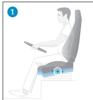
**Váš RECARO Komfort-Plus:** Pomocí vypínače (6) k rychlému spuštění můžete přesunout sedadlo k vystoupení z vozidla do nejnižší polohy. Když přepnete vypínač opět směrem nahoru, přesune se sedadlo pomocí funkce Memory automaticky zpět od vámí předem nastavené výškové polohy.
