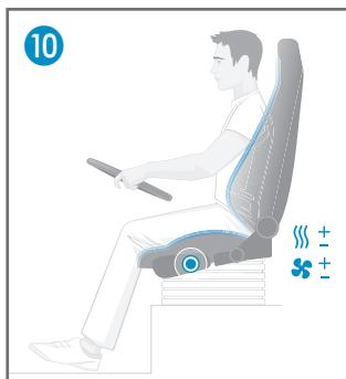
**Votre plus de confort RECARO:** Pour la première fois sur un siège de véhicule utilitaire, votre RECARO C 7000 vous permet d'utiliser simultanément la ventilation et le chauffage pour optimiser l'atmosphère dans l'habitacle. Le tissu 3D Aero perméable à l'air du RECARO C 7000 améliore encore ses excellentes propriétés sur le plan de l'atmosphère.
